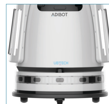
Difuzor si radar LiDar inferior
